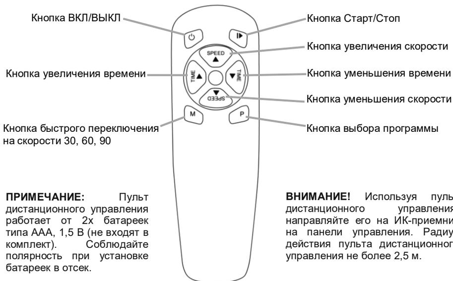
**ПРИМЕЧАНИЕ:** Пульт дистанционного управления работает от 2х батареек типа AAA, 1,5 В (не входят в комплект). Соблюдайте полярность при установке батареек в отсек.
